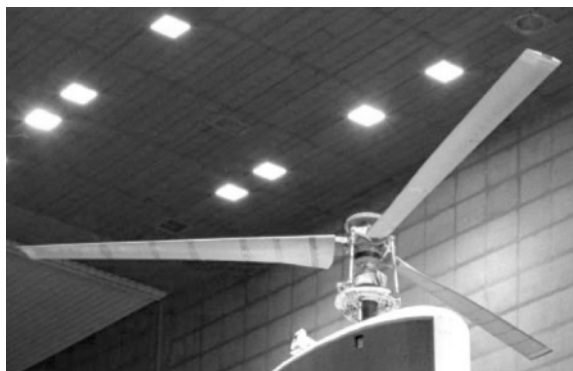
图 2 风洞中的 XV-15 倾转旋翼机的旋翼
